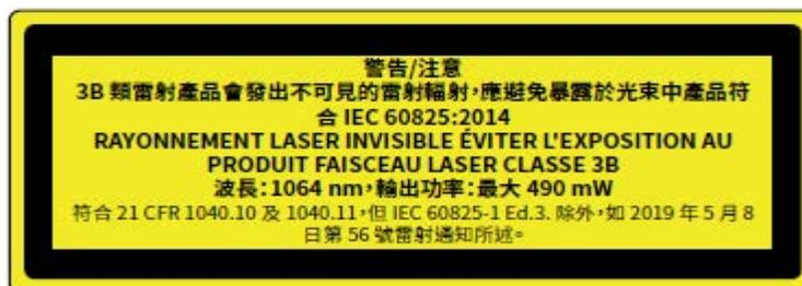
激光信息标签。向用户提供产品内置激光器的等级、波长和输出功率信息。该标签位于分析仪的右侧。
