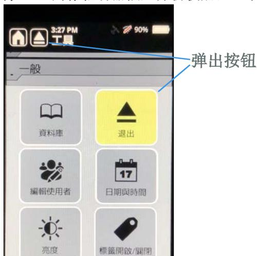
驱动器需要正确弹出，否则内容可能损坏。在拔出闪存驱动器之前，转到“常规”工具选项卡，按“弹出”按钮或点击工具栏上的“弹出”图标。
