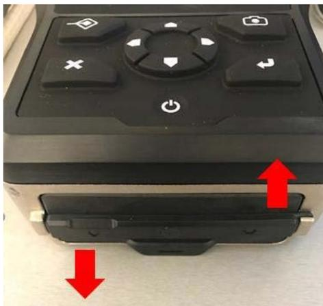
2. 解锁后，电池舱门应如下图所示。剥开电池舱门，露出电池区域。
