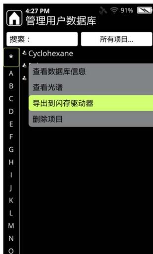
3. 选择“导出项目”，并将项目导出到 USB 闪存驱动器上的 UserAddedLib 文件夹。
