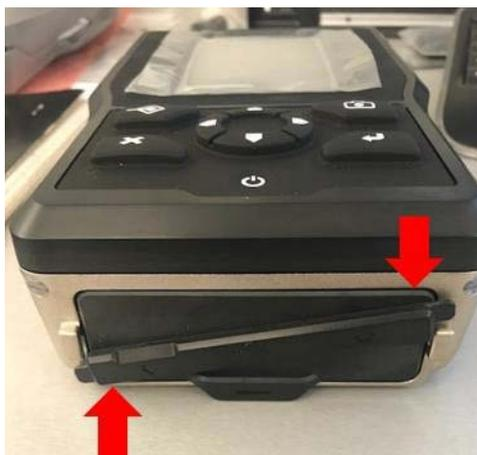
6. 更换电池且舱门牢固关闭后，分析仪的门就会如下图所示。
