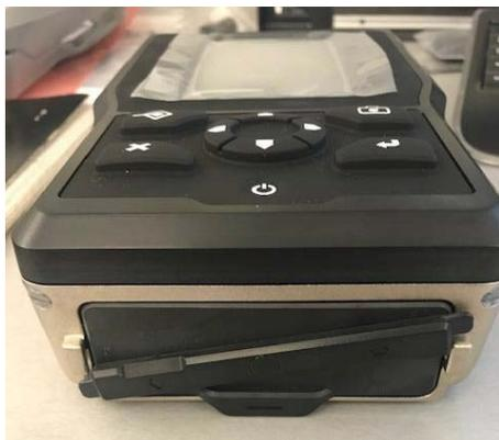
3. 如下图所示，在装入电池时，开槽触点应朝向左上角，以便准备滑入分析仪。
