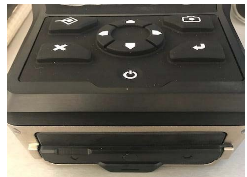
Puerta bloqueada de la batería
