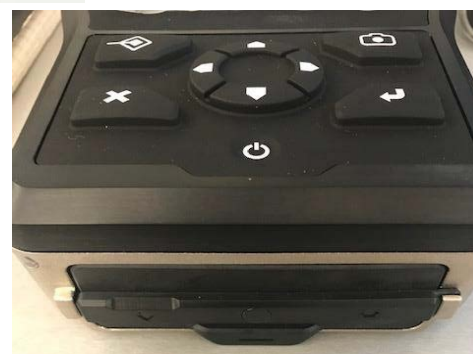
Puerta de la batería bloqueada
