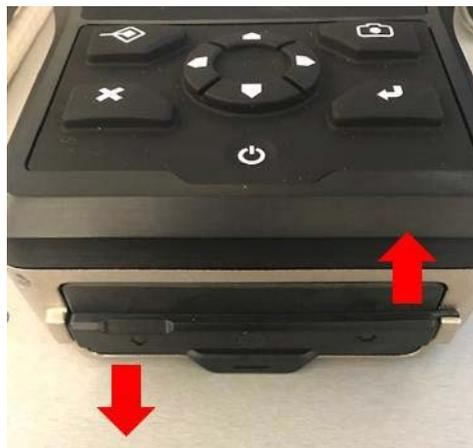
2. Nach dem Entriegeln des Akkus sollte die Klappe wie in folgender Abbildung aussehen. Die Akkufachabdeckung entnehmen, um das Akkufach freizulegen.
