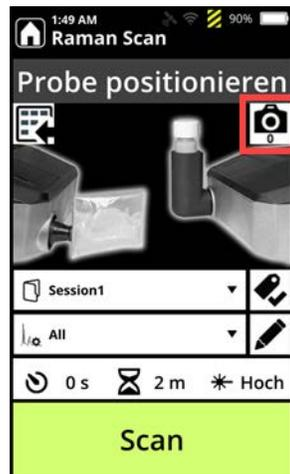
4. Halten Sie den Analyzer über das Bild, das Sie fotografieren möchten, sodass das Kameraobjektiv (an der Unterseite des Analyzers) das Bild aufnehmen kann.
