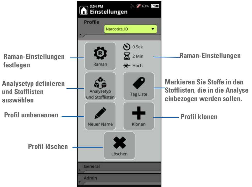
Für Profile mit dem „Screeener analysis type“ (Screeener-Analysetyp) sind die Optionen identisch, außer dass das Symbol für die Meldungsliste das Symbol für die Tag-Liste ersetzt:
