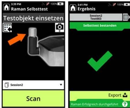
✓ Selbsttest IN ORDNUNG: Der Analyzer hat den Polystyrolstab korrekt erkannt, was auf eine ordnungsgemäße Funktion hinweist.
