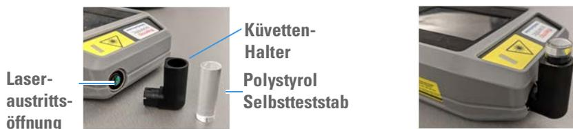
2. Setzen Sie den Polystyrolstab in den Küvettenhalter ein, wie oben gezeigt. Den Stab in dem Halter fest nach unten drücken, damit der Laser in die Probe gelangen kann.
