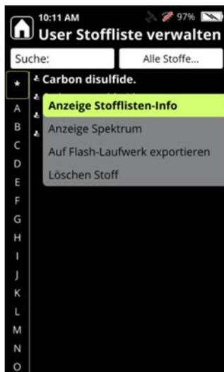
3. Wählen Sie „Stoff exportieren“ und exportieren Sie das Element in den Ordner „UserAddedLib“ auf dem Flash-Laufwerk.
