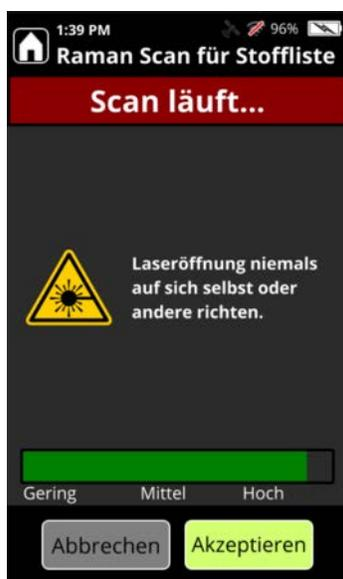
Um Daten optimaler Qualität zu erhalten, lassen Sie den Scan laufen, bis er abgeschlossen ist oder der das Ende des grünen Fortschrittsbalkens erreicht ist. Wenn ein Scanvorgang übermäßig lange dauert, können Sie **Akzeptieren** oder die Eingabetaste drücken, um den Scanvorgang bei einer niedrigeren Scanqualität anzuhalten.
