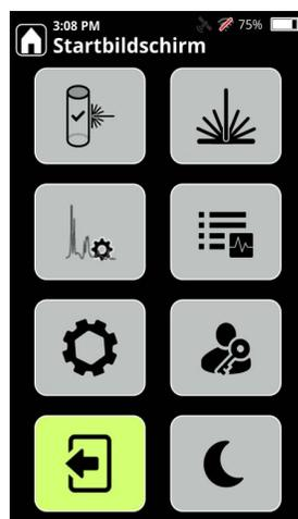
**Hinweis** Wenn Sie den Analysator abmelden, wird der Laser automatisch deaktiviert.
