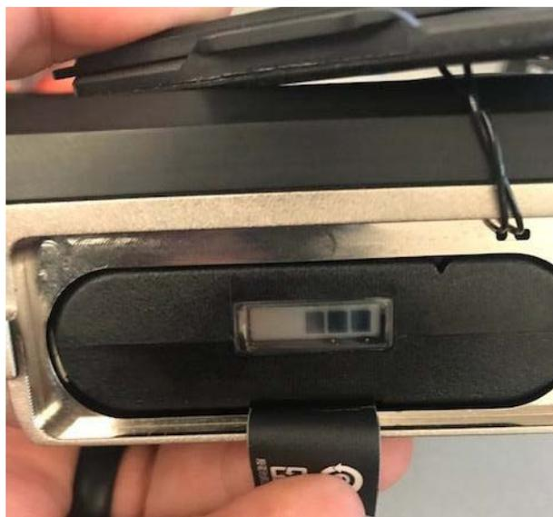
5. Sicherstellen, dass das Akkufach ordnungsgemäß abgedichtet ist:
