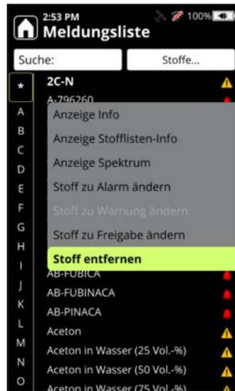
4. Wählen Sie **Stoff entfernen**, um den Stoff aus der Liste zu entfernen.
