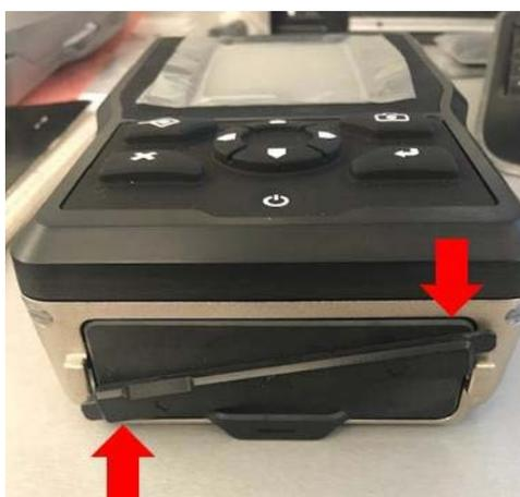
6. Wenn der Akku ausgetauscht und die Abdeckung sicher verschlossen wurde, erscheint das Analyzerfach wie links abgebildet.
