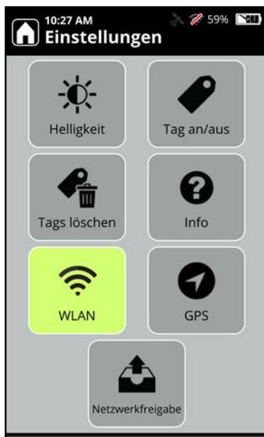
3. Wählen Sie im Bildschirm „WLAN“ die Option „An“ (manuelle Verbindung).
